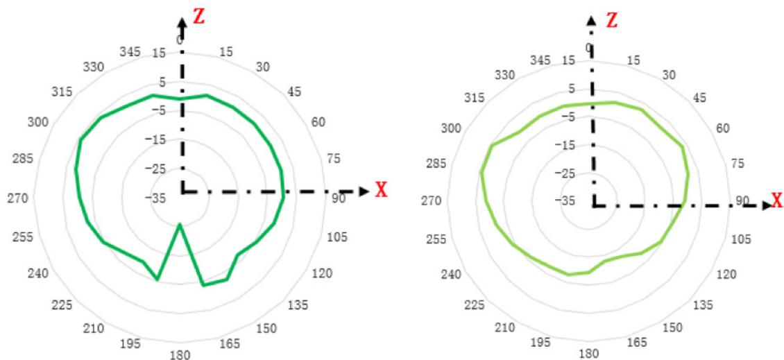
Figura 2. Diagramas de radiación de antena de los modelos AP1361D
