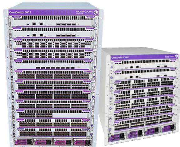
Der OmniSwitch 9900 ist eine modulare Plattform mit hoher Dichte und Multi-Terabit-Kapazität. Über die Plattform kann die Schaltleistung mit der Virtual-Chassis-Technologie linear skaliert werden. So stehen insgesamt mehrere Dutzend Terabit Schaltleistung zur Verfügung. Das modulare Design schützt Investitionen und ermöglicht ein zukünftiges Scale-Out mit kommenden Inline-Upgrades mit einer hohen Dichte und 1G/2.5G/5G/10G/25G/40G/50G/100G-Schnittstellen.
